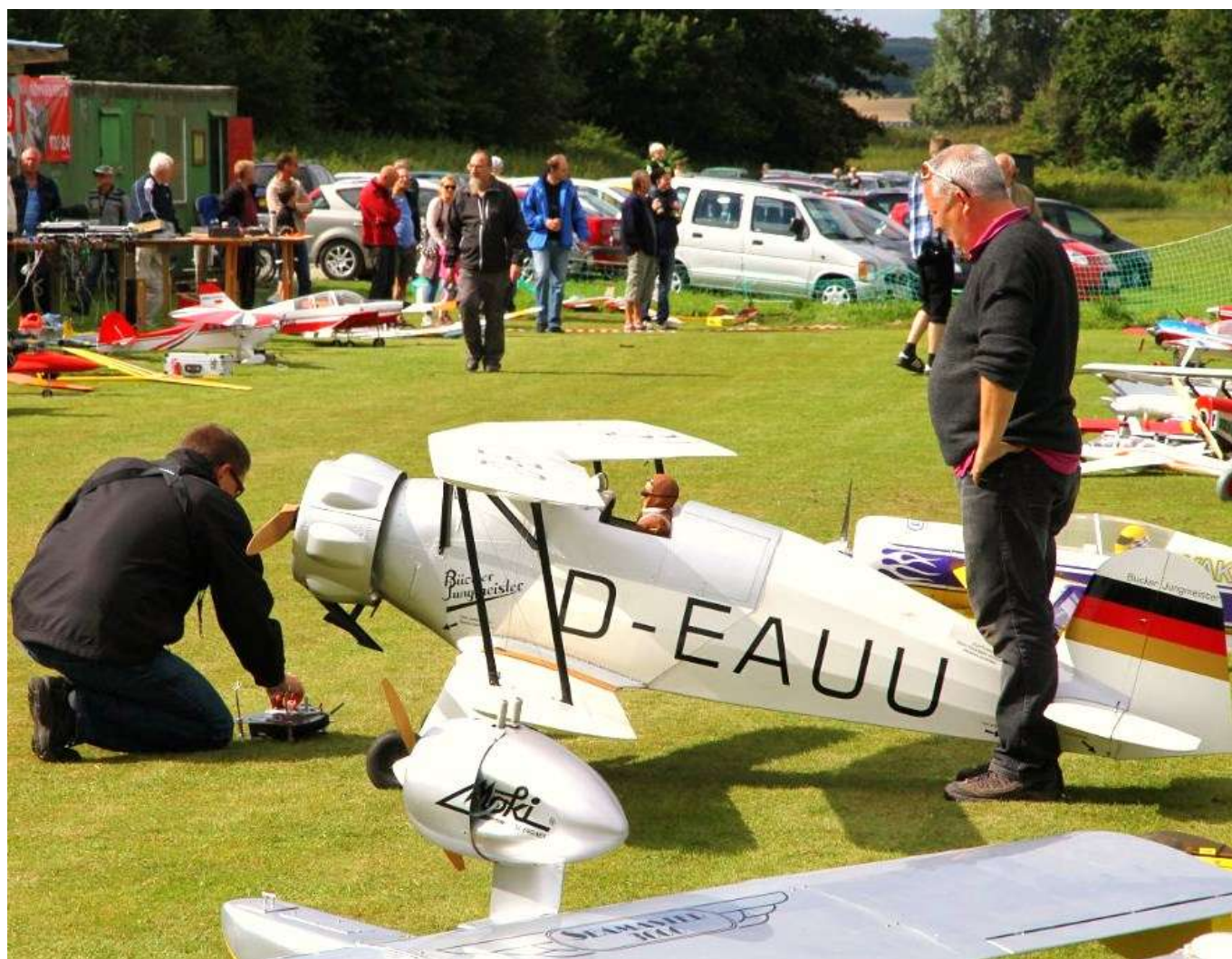
Per Holm gør klar til at starte sin Bücker Jungmeister med en 250cc 5 cyl. MOKI stjernemotor Foto: Lars Klitte
